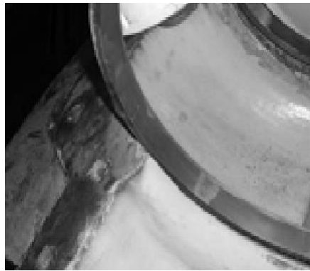
Gambar 1. Deformasi pada Casing wear ring
