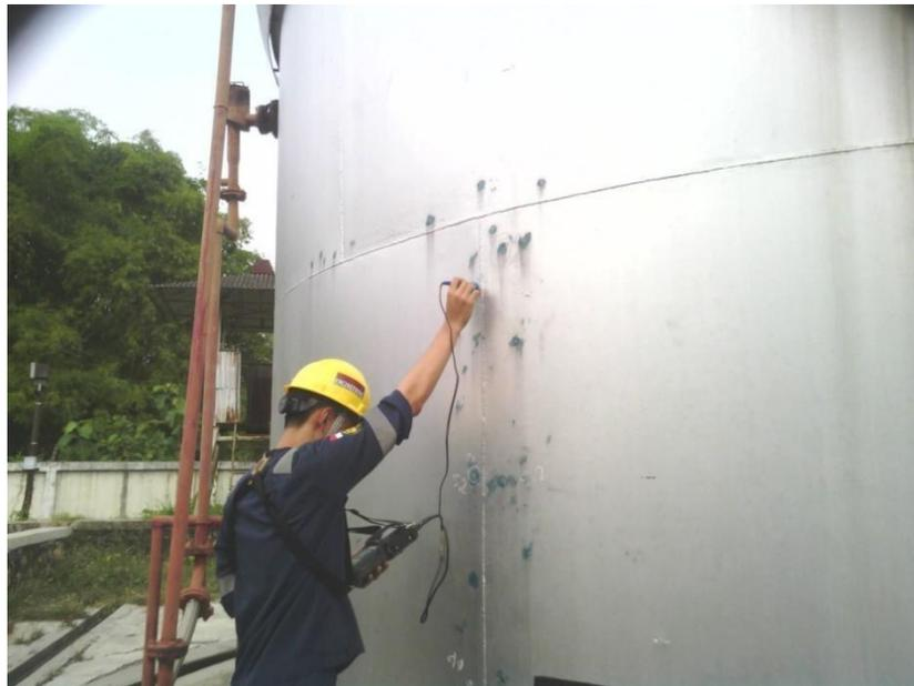
**Gambar 2. Pengukuran Ketebalan Aktual Menggunakan UT Thickness Gauge**
