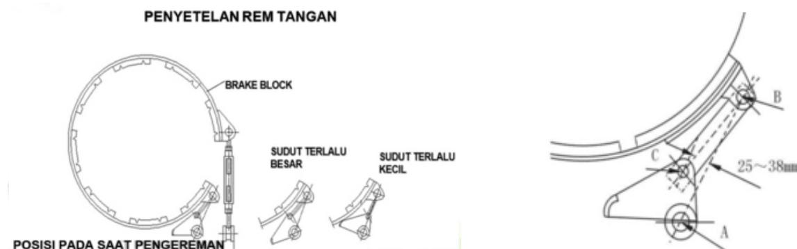
Gambar 7. Penyetelan rem tangan yang benar
