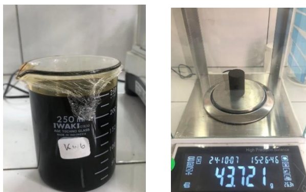
Gambar 4. Saturasi Core Menggunakan Sampel Minyak Kawengan Dan Ditimbang Berat Basah (wet weight)
