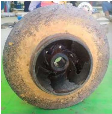
Uniform surface corrosion dan erosion corrosion pada impeller
