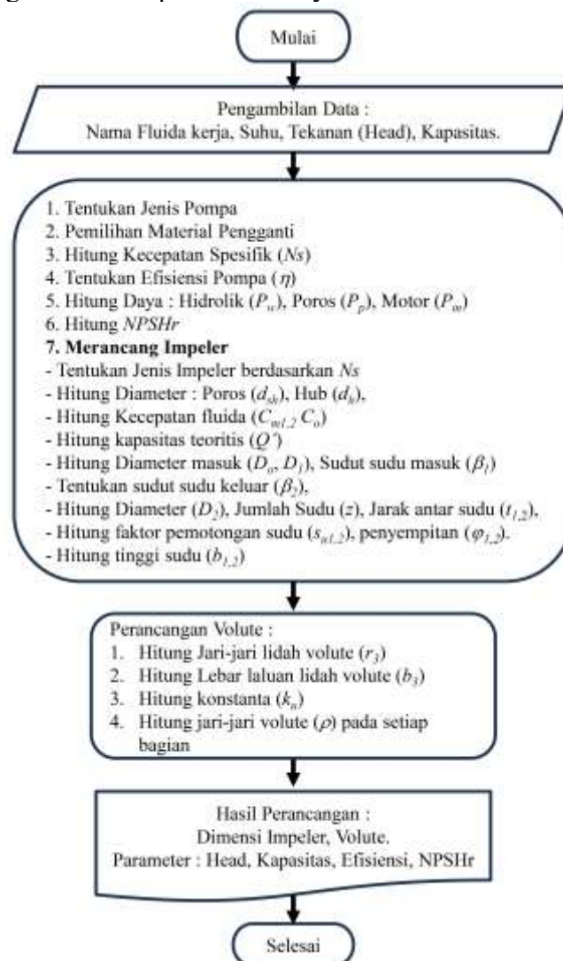
Gambar 2. Flowchart Urutan Penelitian Perancangan Pompa Sentrifugal
