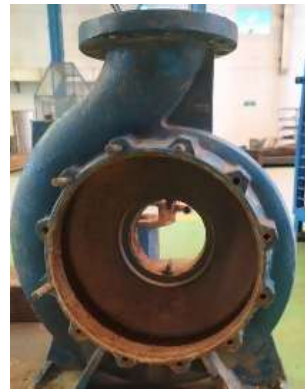
Uniform surface corrosion dan erosion corrosion pada volute chamber.
