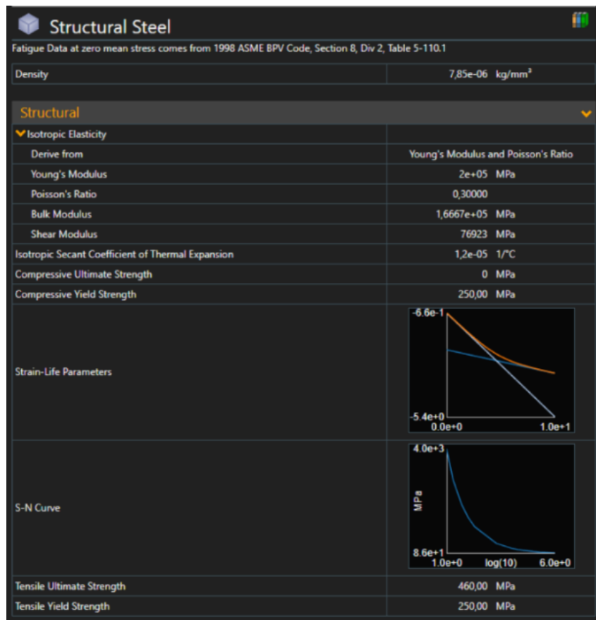
Gambar 6. Penambahan Material Pada Model Bearing
