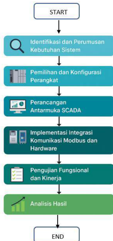
Gambar 2. Flowchart Pembuatan Sistem Scada Multivendor
