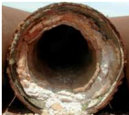
Gambar 2. Scale yang terbentuk pada trunkline [1]
