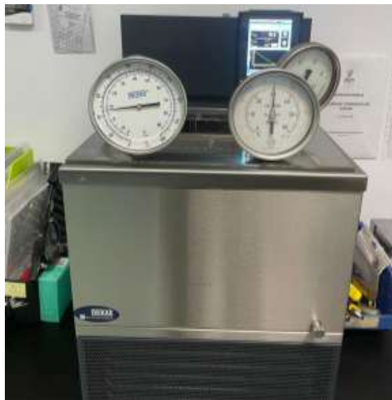
Gambar 4 Setup kalibrasi temperature gauge dengan probe terendam dalam oil bath pada kedalaman imersi minimal 6 cm
