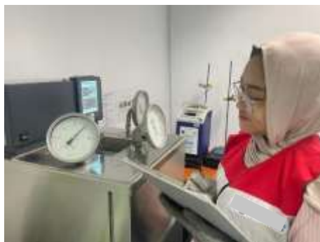
Gambar 6 Proses kalibrasi temperature gauge menggunakan WIKA CTB9500 di workshop instrumentasi PT. TG
