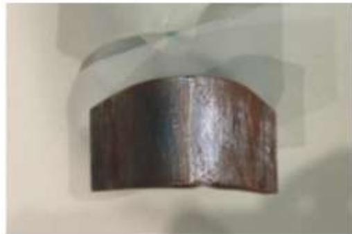
Gambar 15. Kurva dan Hasil Spesimen Face Bend 11
