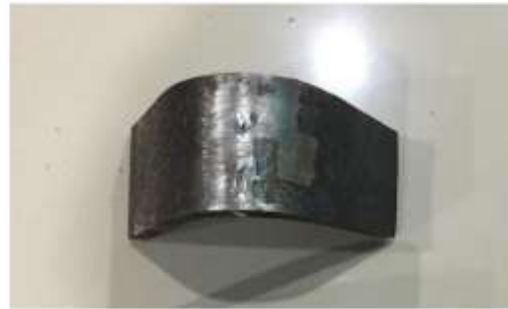
Gambar 14. Kurva dan Hasil Spesimen Root Bend 11
