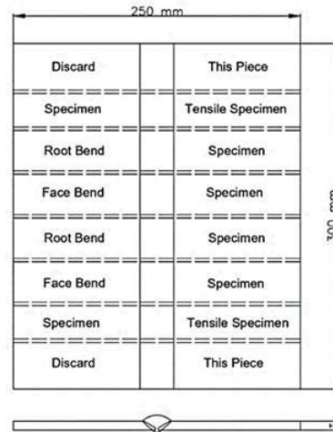
Gambar 2. Bagian Pemotongan Spesimen Uji Tekuk dan Uji Tarik
