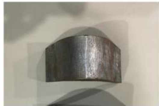
Gambar 12. Kurva dan Hasil Spesimen Root Bend 1
