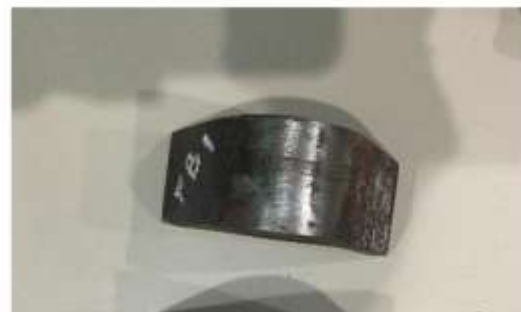
Gambar 13. Kurva dan Hasil Spesimen Face Bend 1
