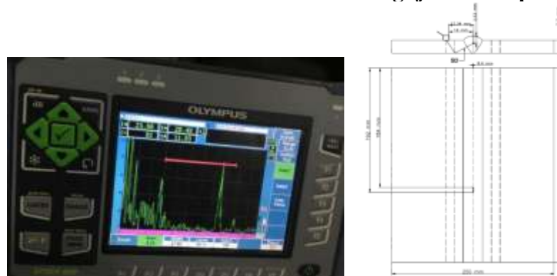
Gambar 7. Grafik dan Sketsa Cacat 2 Pengujian Plat Spesimen
