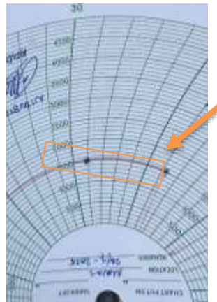
Gambar 9. Pembacaan tekanan 1500 psi menggunakan Barton Chart pada pengujian tekanan rendah Annular Preventer 13 5/8 inci
