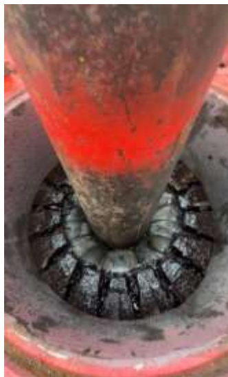
Gambar 10. Kondisi Close Annular Preventer
