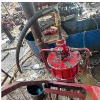
Gambar 2. Pompa hidrolik dan jalur tekanan ( pressure line ) yang menghubungkan HCU dengan annular preventer .
