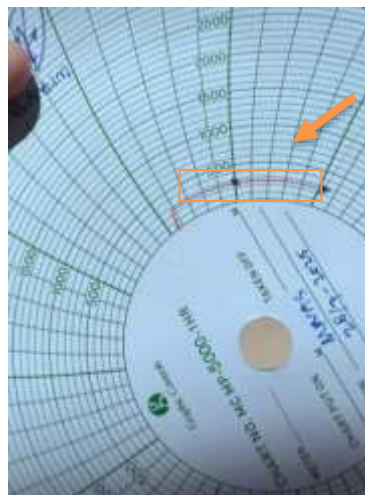
Gambar 7. Pembacaan tekanan 250 psi menggunakan Barton Chart pada pengujian tekanan rendah annular preventer 13 5/8 inci
