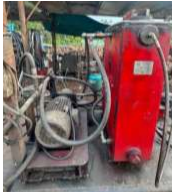
Gambar 1. Hydraulic Control Unit (HCU) sebagai sumber tekanan utama pada sistem pengujian BOP di Workshop PT Asrindo Citraseni Satria
