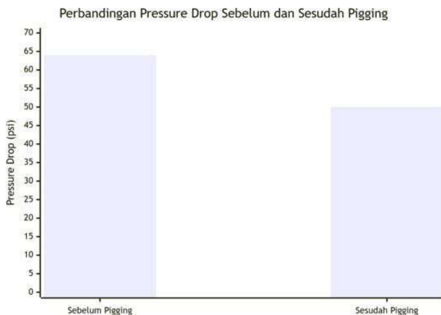
Gambar 2: Perbandingan Pressure Drop Sebelum dan Sesudah Pigging
